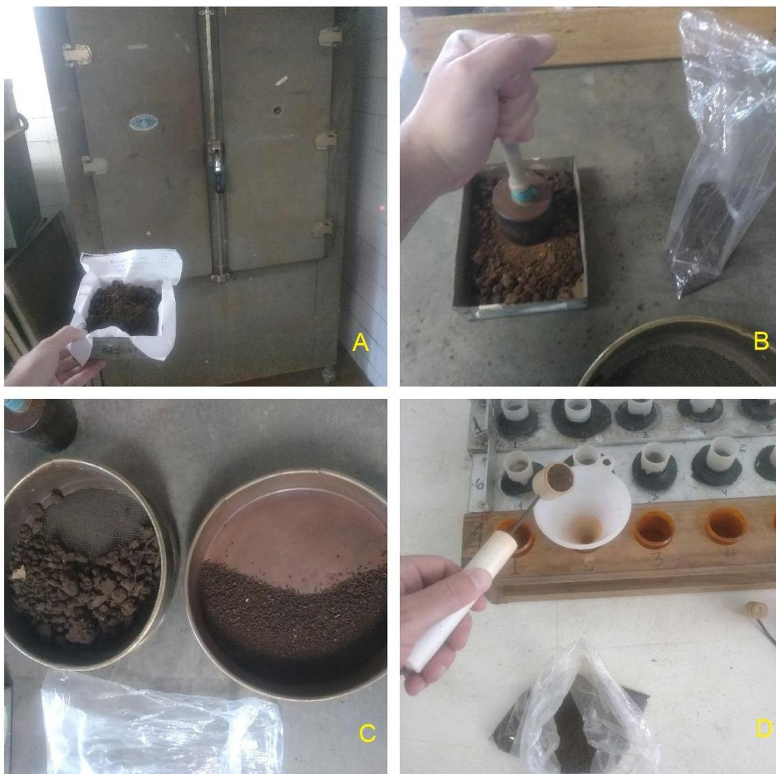
FIGURA 16: Fase pré análise. A. Amostra de solo devidamente preparada antes de ir para a estufa; B. Em alguns casos se fez necessário realizar a moagem dos torrões maiores de solo antes da peneiragem; C. Comparação entre uma porção de solo natural e outro já peneirado de mesma amostra; D. Distribuição das amostras de solo nos recipientes com auxílio do cachimbo.
