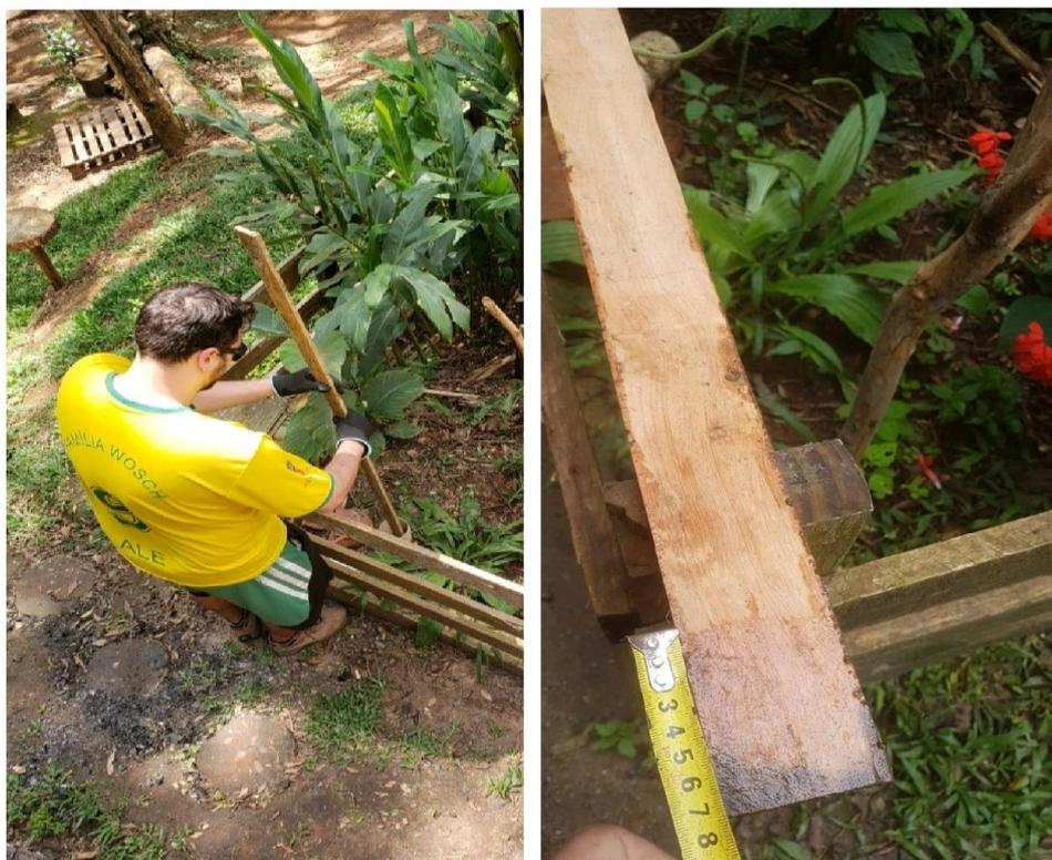
FIGURA 12: Monitoramento do nível do efluente dentro da BET. Lado esquerdo – o autor insere a ripa de madeira na tubulação interna à BET. Lado direito – com o auxílio da trena é feita a leitura do nível de efluente na BET. Fonte: o Autor, 2022.
