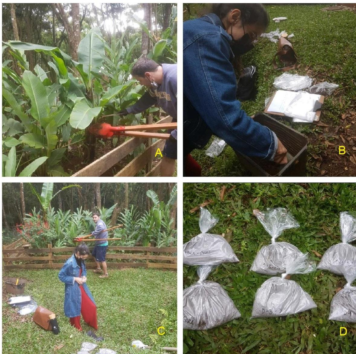
FIGURA 13: Coletas em campo. A. O autor se utiliza de uma régua transparente e uma cavadeira articulada para realizar a tarefa de abrir as covas na BET; B. Luiza Natalino realizando a mistura dos solos no balde; C. O autor ao fundo próximo a BET enquanto Luiza auxilia no ensacamento e identificação das amostras; D. As amostras homogêneas devidamente identificadas para serem levadas ao laboratório. Fonte: o Autor, 2022.
