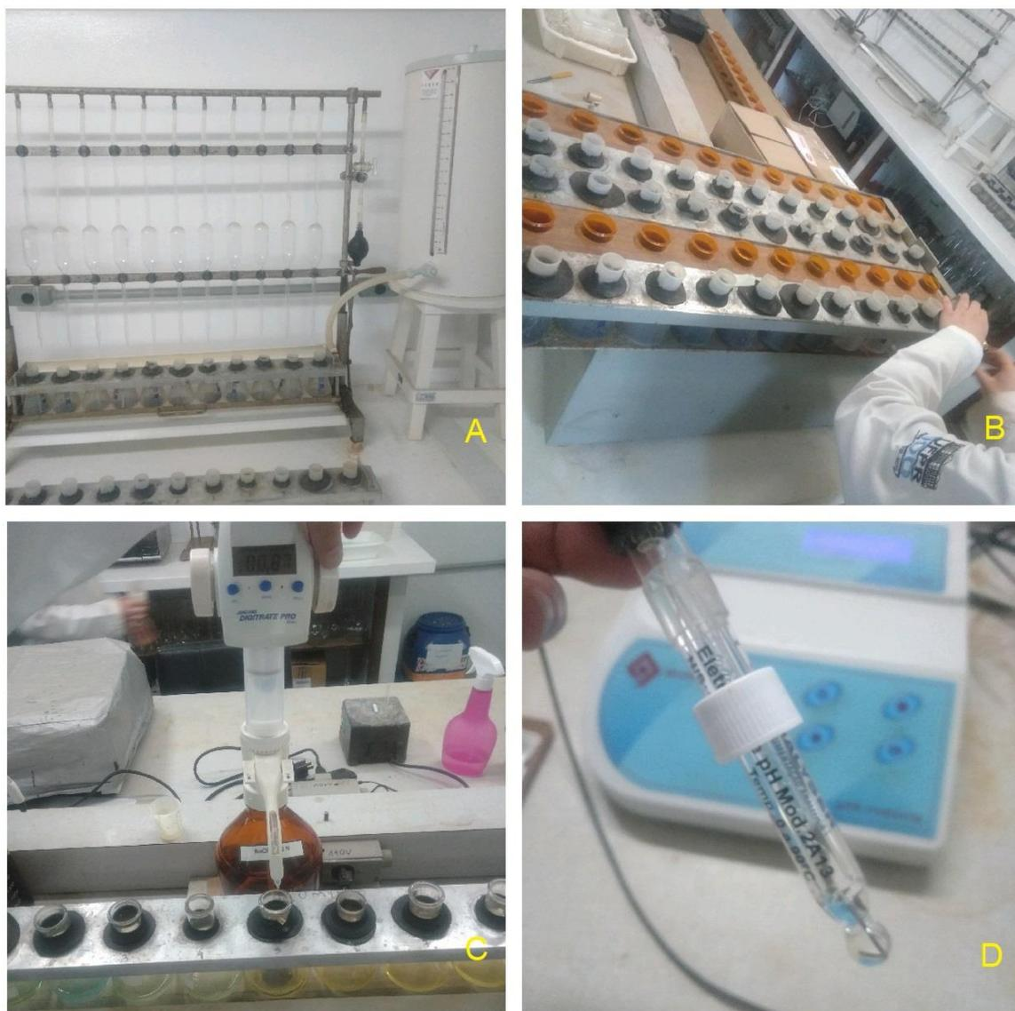
FIGURA 17: Etapas no laboratório. A. Adição de solução Mehlich I nos recipientes contendo amostras, procedimento para a determinação de P, K e Na; B. Amostras sendo colocadas no agitador mecânico. C. Determinação do Al sendo realizada com solução de NaOH na bureta automática; D. pHmetro de bancada utilizado para leitura de pH.
