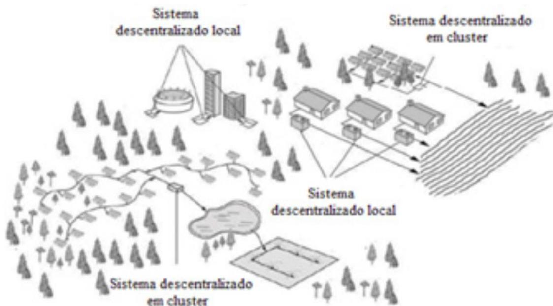
FIGURA 4: Exemplos de sistemas descentralizados individuais e em cluster para tratamento de esgoto sanitário. Fonte: Mesquita, 2021.
