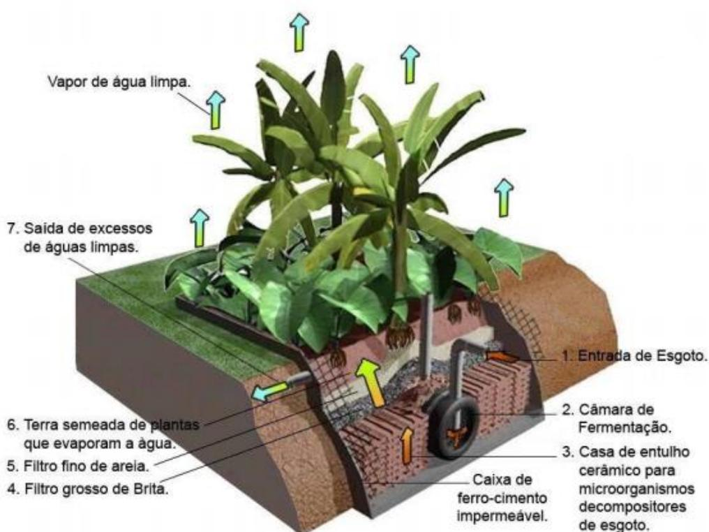
FIGURA 5: Bacia de evapotranspiração - disposição das camadas e sentidos de funcionamento (setas). Fonte: Rocha, 2021 (adaptado de Galbiati, 2009).
