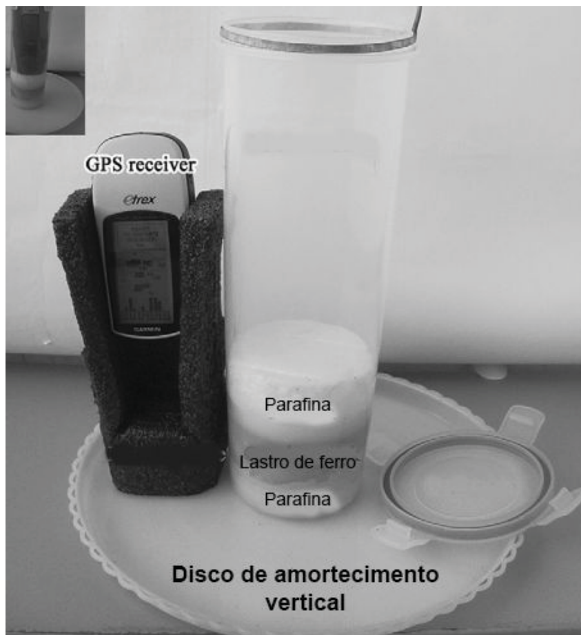
Figura 15 – Derivador desenvolvido por (SABET; BARANI, 2011) com destaque para o disco de amortecimento de movimentos verticais Fonte: Adaptado de Sabet e Barani (2011)
