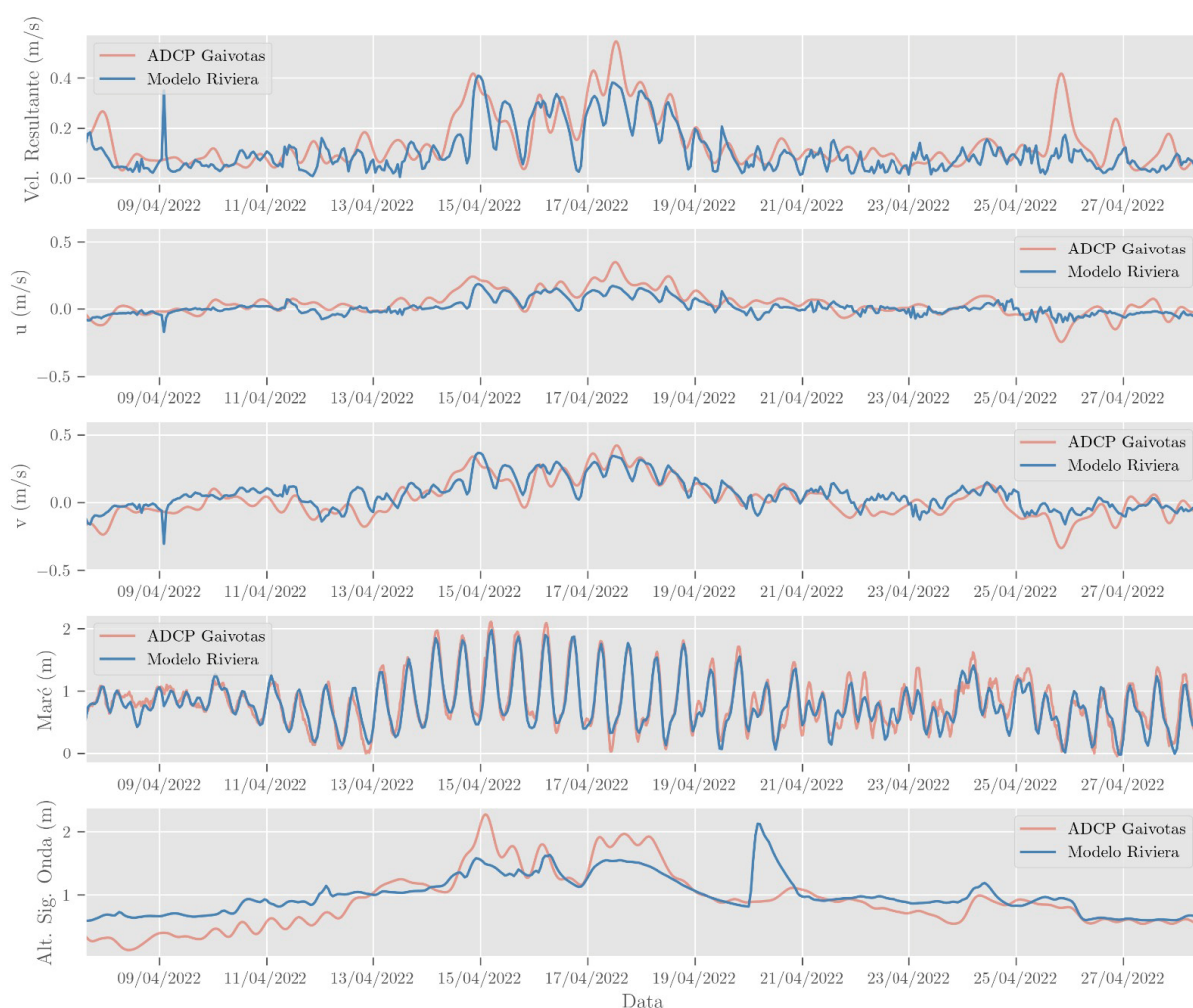
Figura 60 – Comparação entre componentes de velocidade, oscilação da maré e altura significativa de ondas medidas pelo ADCP e calculadas pelo modelo
