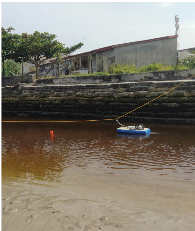
Figura 35 – Levantamento simultâneo com derivador e ADCP na desembocadura do rio Matinhos
