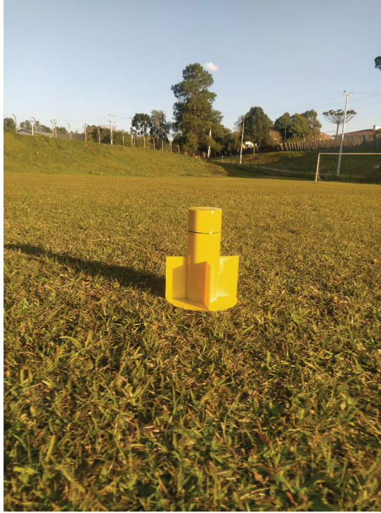
Figura 33 – Derivador posicionado em campo aberto para realização do teste estático para avaliação dos sensores GNSS
