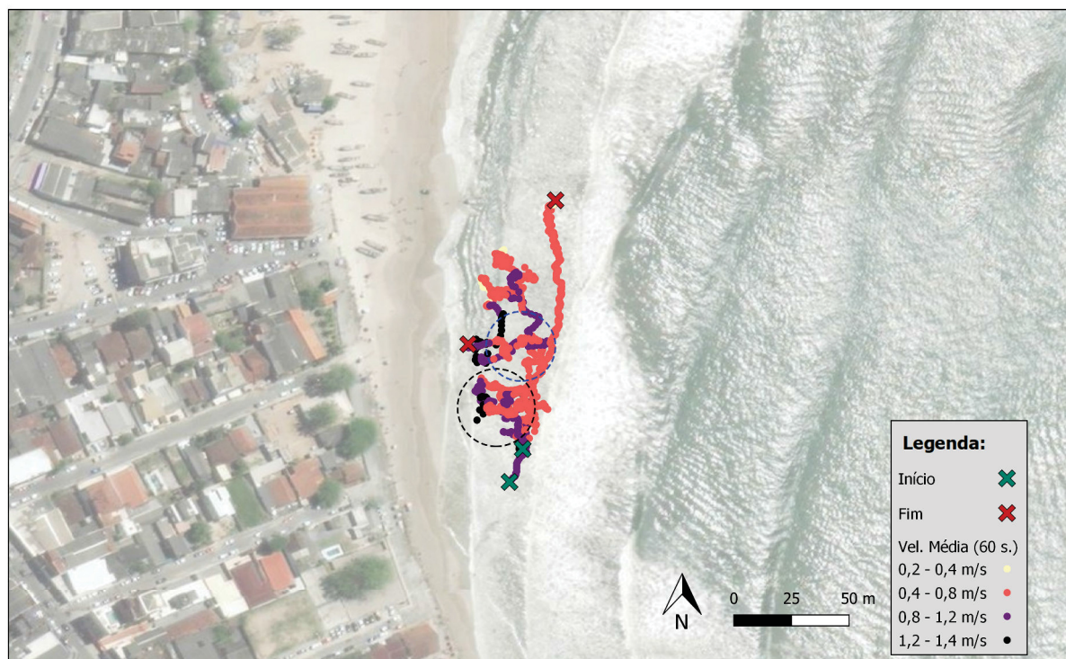
Figura 51 – Mapa de distribuição espacial das velocidades instantâneas de ambos derivadores com destaque para localização de pontos com fluxos de retorno verificados em 19/02/2020
