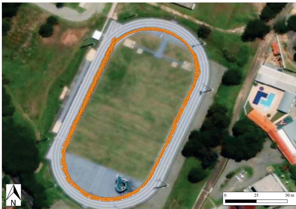
Figura 34 – Nuvem de pontos registrados pelo sensor GNSS durante os caminhamentos do teste cinemático
