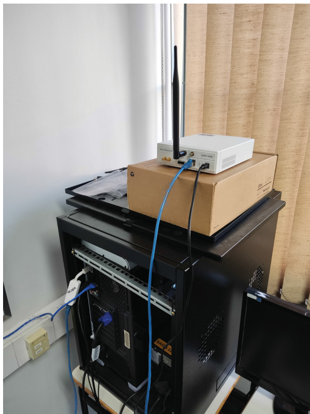
Figura 11 – Servidor com o USRP N210 conectado em sua porta ethernet
