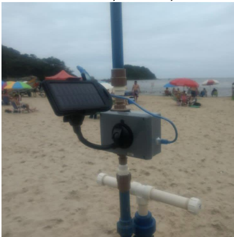
FIGURA 3 - SENSOR MEDIDOR DE VAZÃO, ACOPLADO A UM MICROCONTROLADOR ARDUINO PARA A LEITURA E GRAVAÇÃO DAS MEDIÇÕES.
