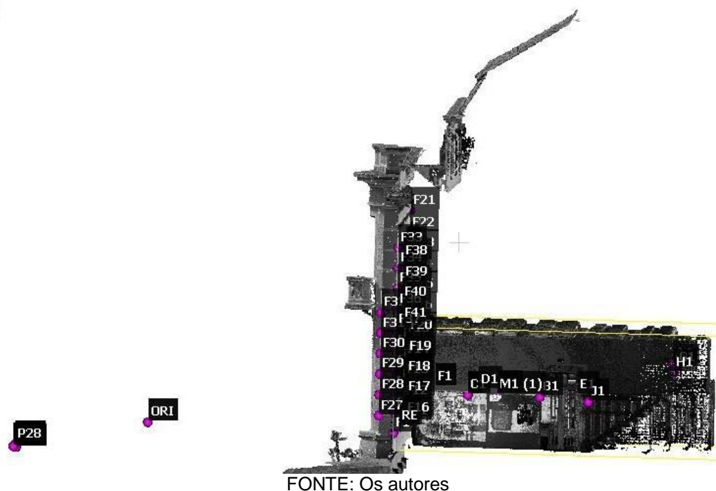
FIGURA 29 – AS NUVENS DOS DOIS PROCESSAMENTOS VISTA EM PERFIL LATERAL
