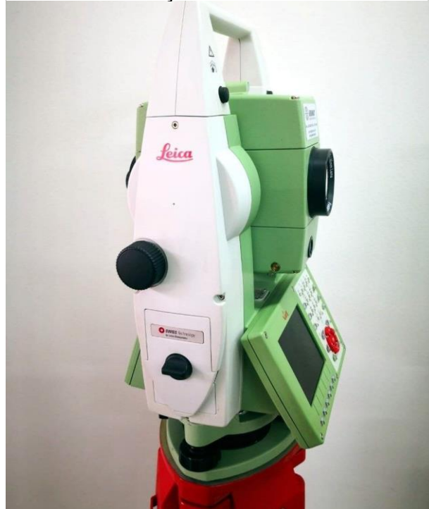
FIGURA 7 – ESTAÇÃO TOTAL ROBÓTICA TS15
