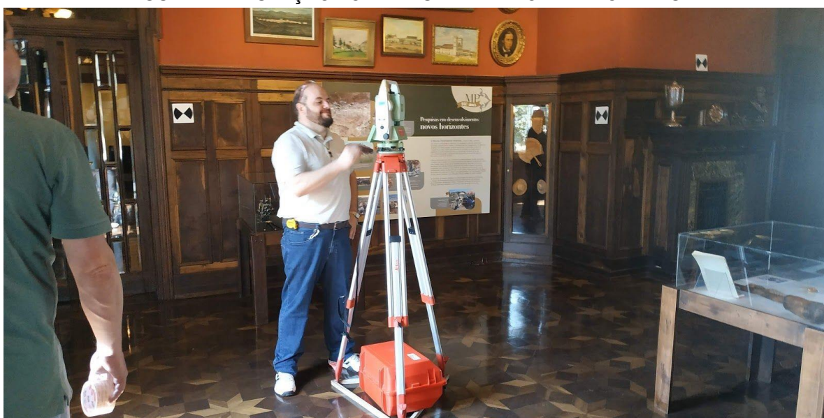
FIGURA 12 – ESTAÇÃO TOTAL INSTALADA NO INTERIOR DA SALA
