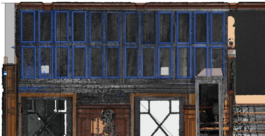
FIGURA 32 – MODELAGEM EM CIMA DA NUVEM DE PONTOS
