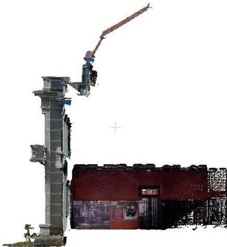
FIGURA 44 – UNIÃO DAS NUVENS DE PONTOS
