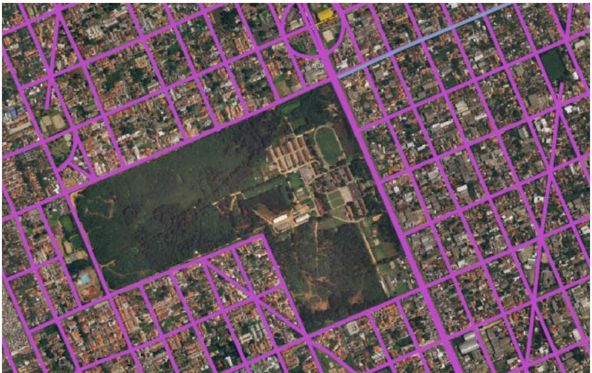
Figura-33: Região do quartel do Boqueirão após processo de vetorização do arruamento do ano de 2008 no QGIS (FONTE: O autor, 2019).
