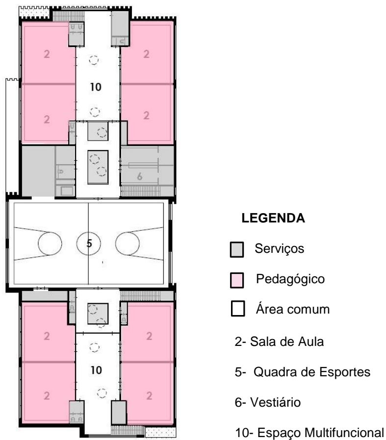
FIGURA 34: PLANTA PRIMEIRO PAVIMENTO FONTE: DEZWARTEHOND (2015 pg.3)
