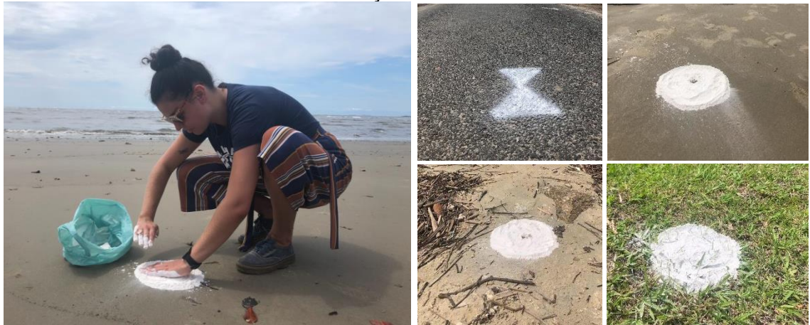
FIGURA 11 - SINALIZAÇÃO DO APOIO TERRESTRE
