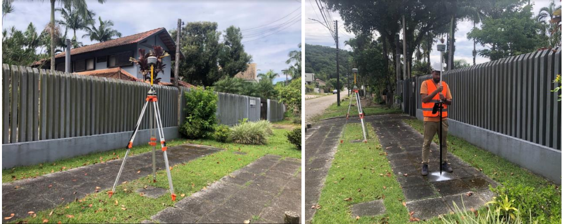
FIGURA 10 - RASTREIO DA BASE GNSS
