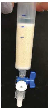
FIGURA 3.1 – COLUNA MONTADA COM RESINA IRA-900 PARA A EXTRAÇÃO DE GLIFOSATO, AMPA E GLUFOSINATO.
