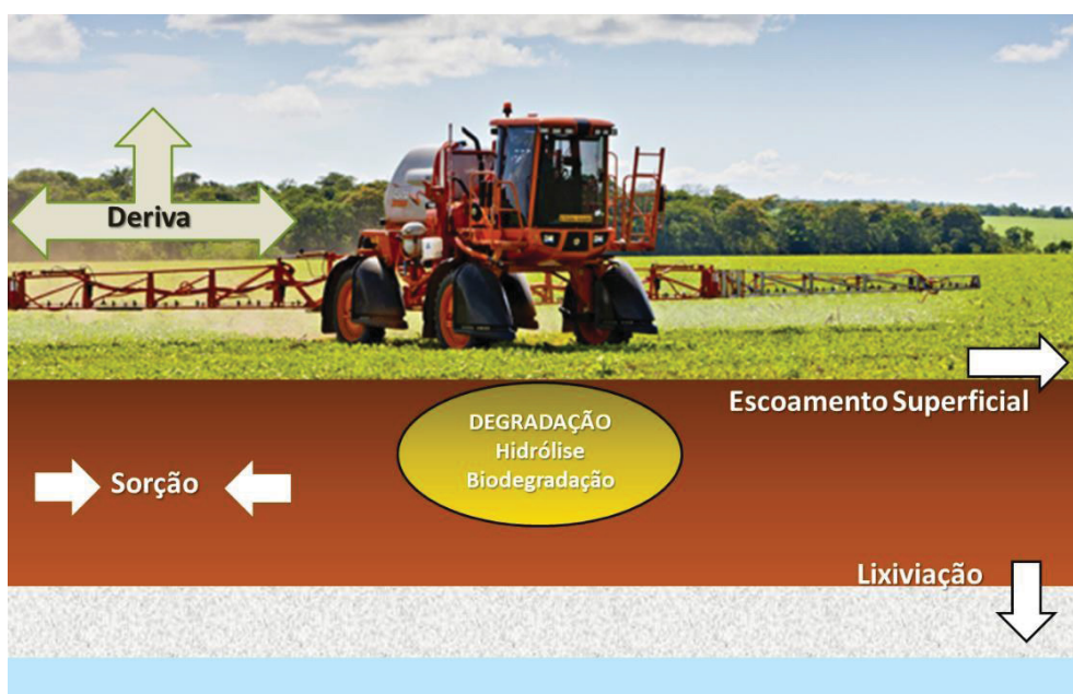
FIGURA 1.2 - REPRESENTAÇÃO DOS TIPOS DE INTERAÇÃO E TRANSPORTE DOS AGROTÓXICOS NO AMBIENTE
