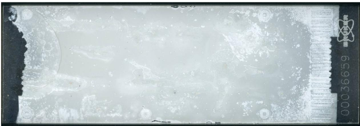
Figura 12: Imagem da lâmina de ITO escaneada. A camada branca é a deposição da matriz DAN. Pode ser observado que ela está mais espessa quando se compara com a imagem B, com a deposição ideal, e também está heterogênea em alguns pontos.
