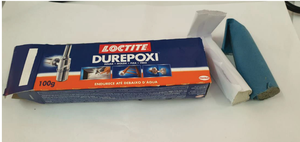
FIGURA 49 – RESINA USADA PARA JUNTAS
