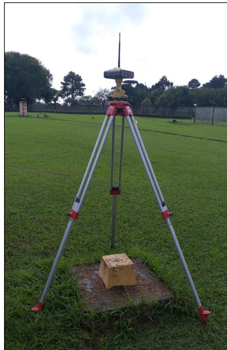
FIGURA 7 - BASE INSTALADA SOBRE A RM3
