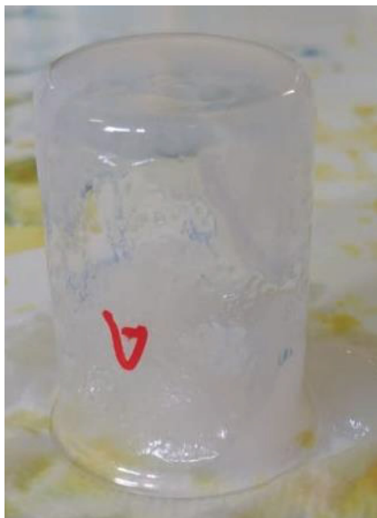
Figura A 1 - Tilt tube test realizado para hidrogel contendo 6 mL da dispersão de ALG 2% (m/V) e 400 \mu L de HNO 3 .
