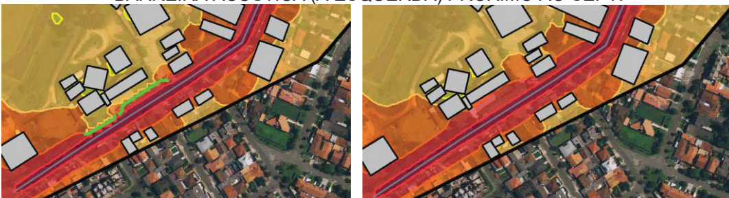
Figura 40 - COMPARAÇÃO DO CENÁRIO DE REFERÊNCIA (A DIREITA) E CENÁRIO COM BARREIRA ACÚSTICA (A ESQUERDA) PRÓXIMO AO SEPT.
