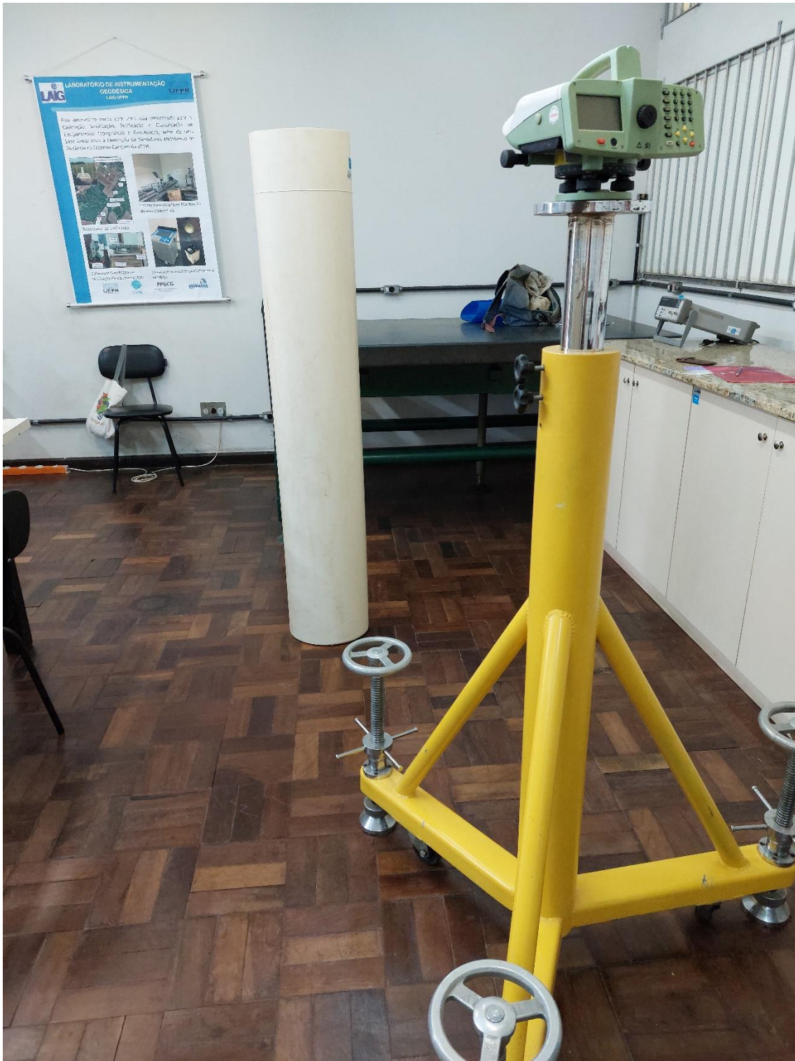
Figura 18 - Nível Geodésico Leica DNA03 instalado no tripé industrial visando a Seção de Referência implantada na tubulação DN300
