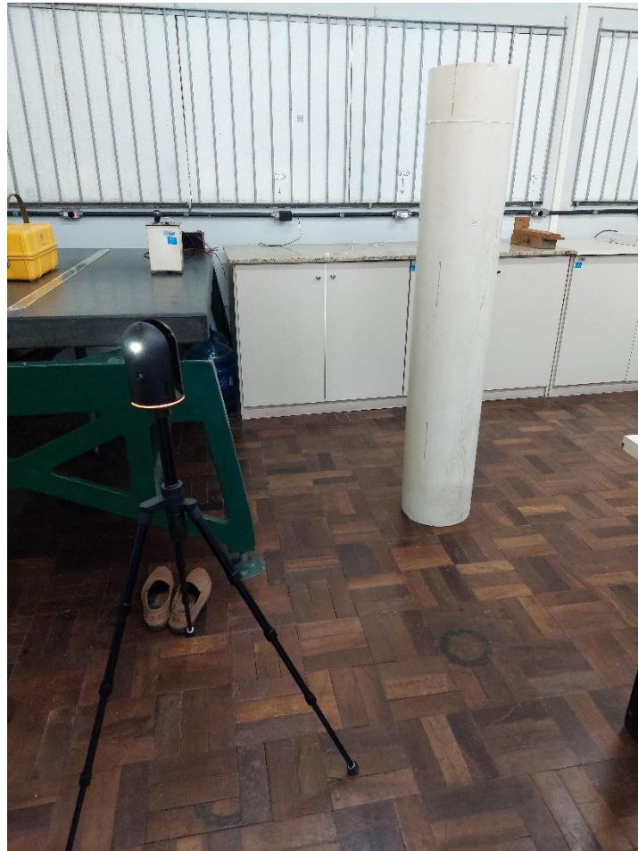
Figura 31 - Laser Scanner em funcionamento
