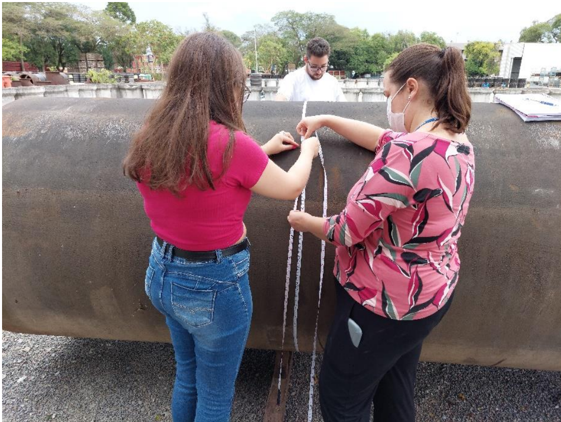
Figura 56 - Método de Arqueamento
