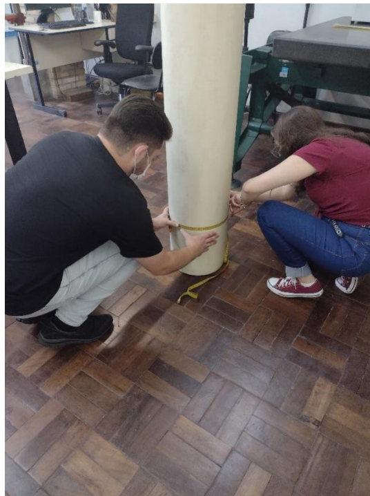
Figura 25 - Mensuração de um curso com o uso de Fita Métrica de PVC pelo Método de arqueamento
