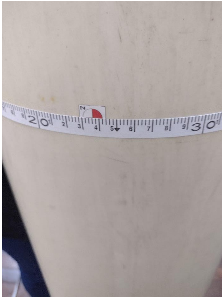
Figura 23 - Trena Métrica de PVC devidamente horizontalizada materializando um curso passando sobre uma seção
