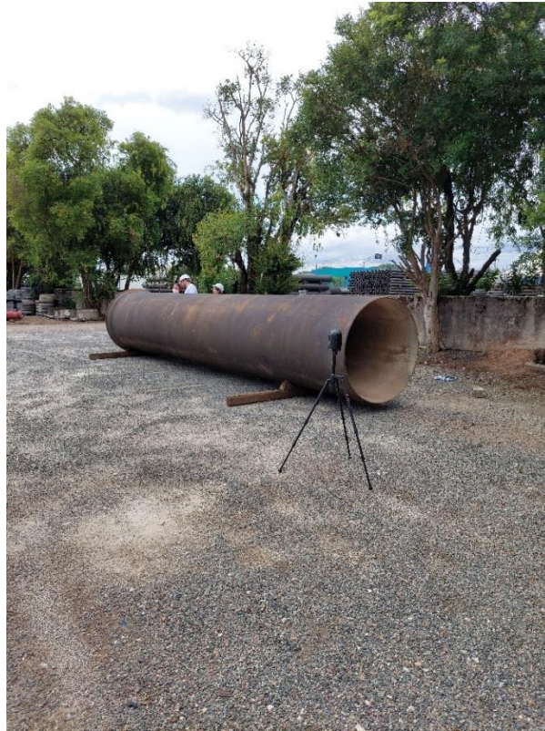
Figura 63 - Laser Scanner Instalado em uma posição fazendo varredura terrestre
