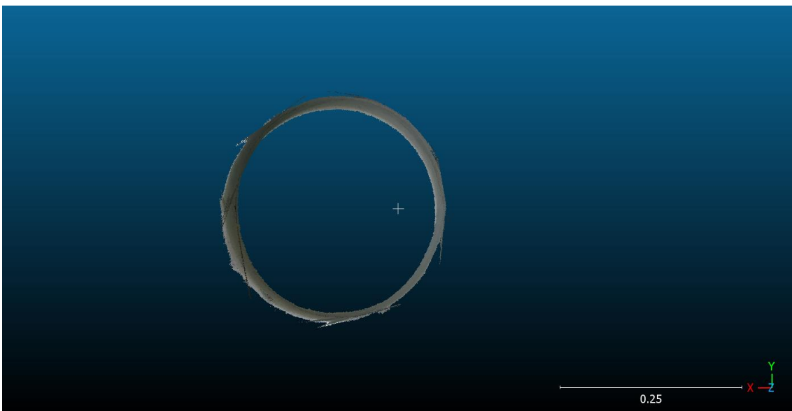
Figura 42 - Vista frontal da nuvem de pontos que está reconstruindo a tubulação DN300 no software CloudCompare
