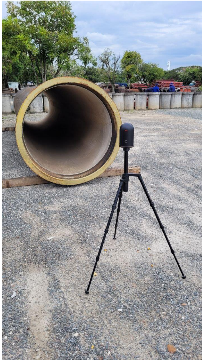
Figura 10 - Laser Scanner Leica BLK360 no Ensaio da SANEPAR
