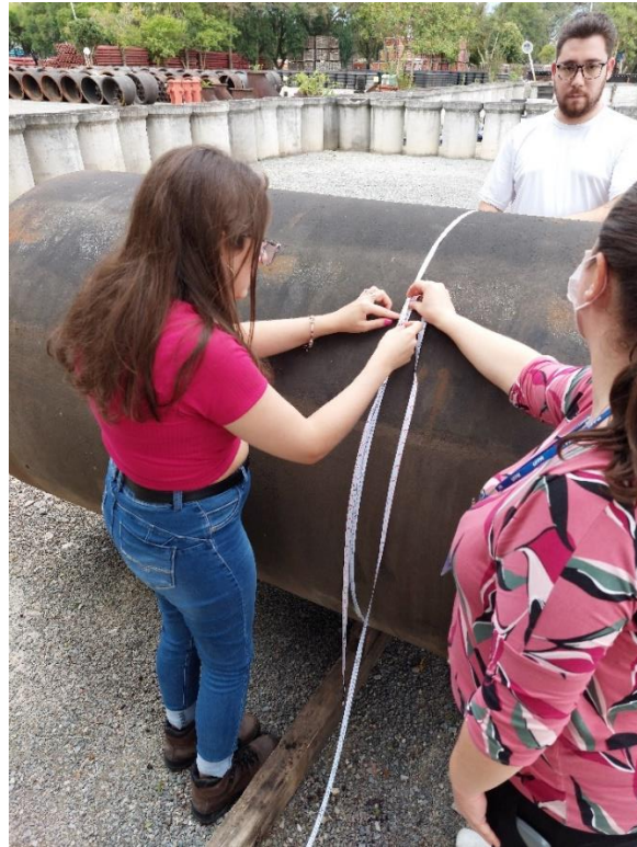
Figura 57 - Método de Arqueamento
