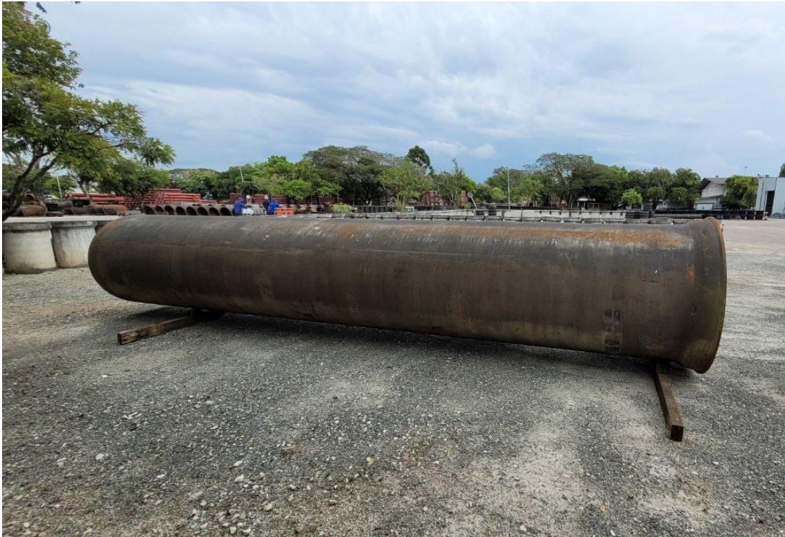
Figura 9 - Tubulação de Água DN1200
