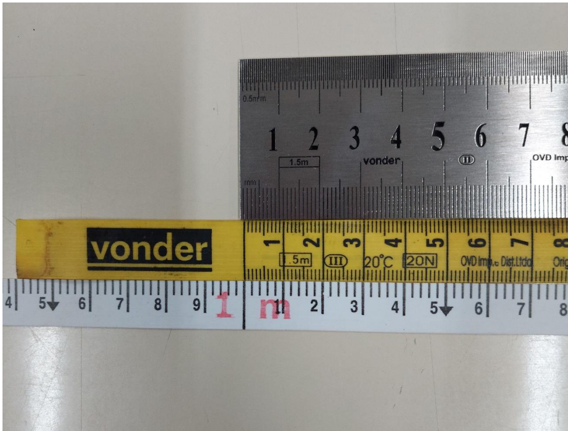
Figura 13 - Trensas de fita e metro padrão posicionados em seu início
