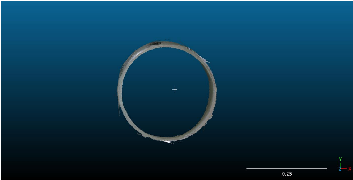
Figura 41 - Vista frontal da nuvem de pontos que está reconstruindo a tubulação DN300 no software CloudCompare
