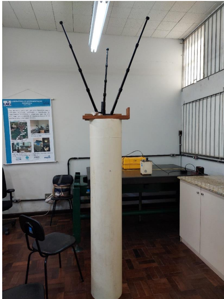
Figura 32 - Laser Scanner realizando a varredura interna na tubulação DN300
