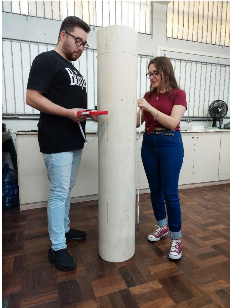
Figura 26 - Mensuração de um curso com o uso de Trena Métrica de Fita de PVC pelo Método de arqueamento
