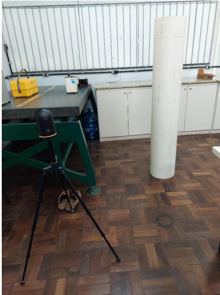
Figura 30 - Laser Scanner Instalado em uma posição fazendo varredura terrestre
