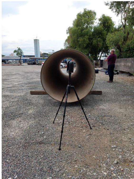
Figura 64 - Laser Scanner Instalado em uma posição fazendo varredura terrestre
