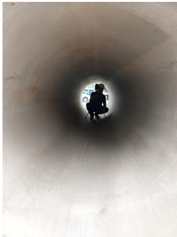
Figura 66 - Laser Scanner Instalado em uma posição internamente à tubulação, fazendo varredura terrestre
