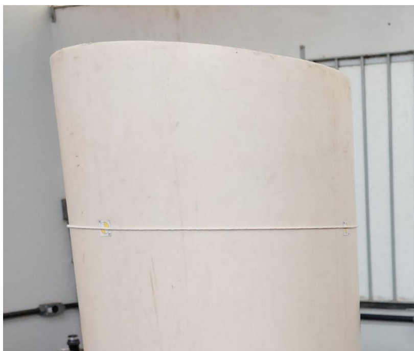
Figura 16 - Seção de Referência materializada com o barbante e os alvos
