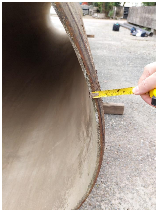
Figura 54 - Realizando a medição da espessura na tubulação DN1200
