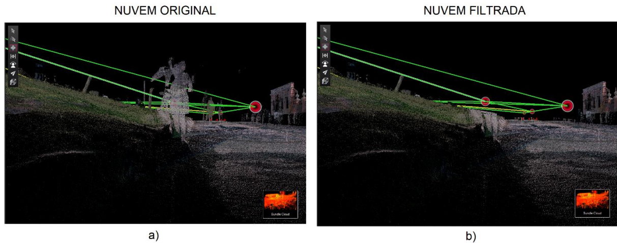
Figura 15 - Exemplo de filtragem, no software Cyclone REGISTER Fonte: Autora (2022).
