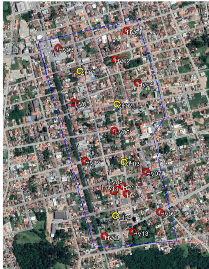
FIGURA 26 - PONTOS DE APOIO E VERIFICAÇÃO
