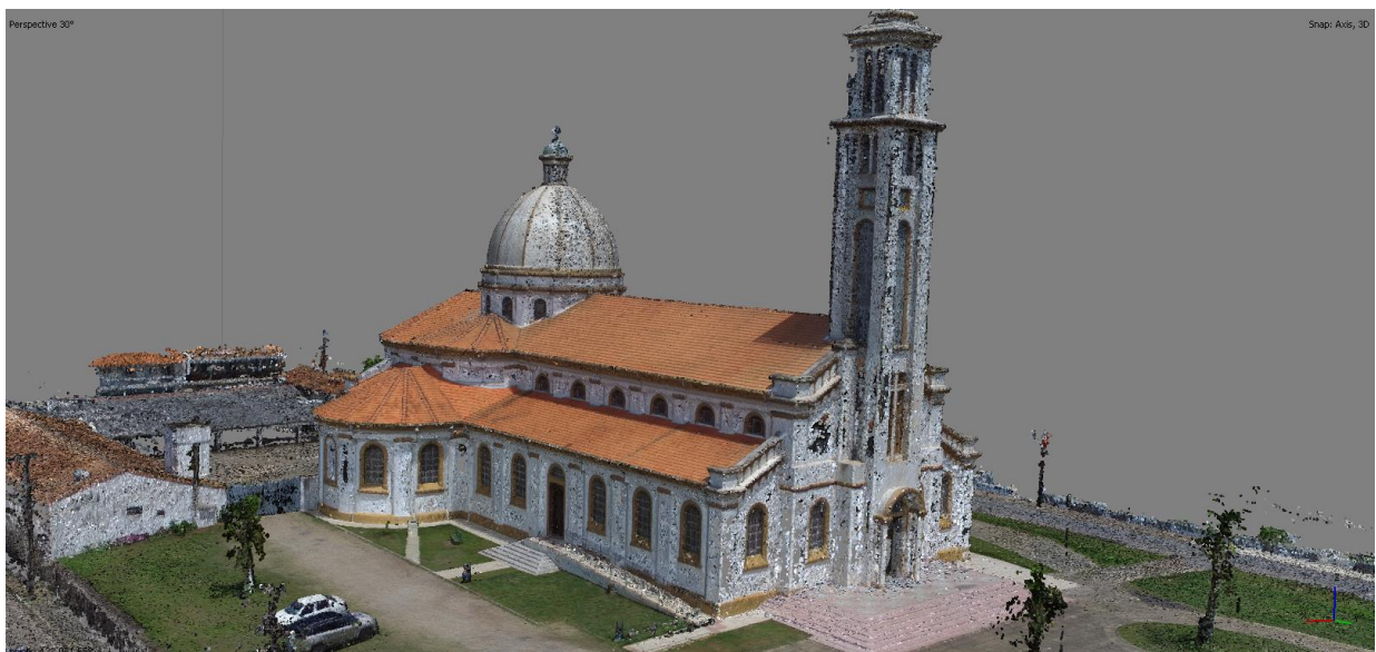
FIGURA 52 - NUVEM DE PONTOS DETALHES - FACHADA
