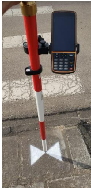
FIGURA 23 - RASTREIO DOS PONTOS DE VERIFICAÇÃO
