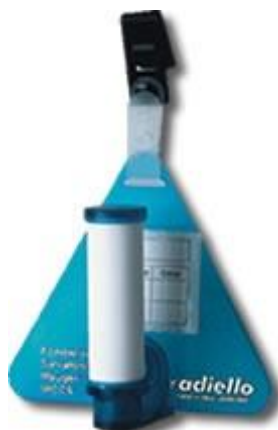
FIGURA 6 – CONJUNTO DE AMOSTRAGEM PASSIVA PARA COV. FONTE: RADIELLO (2015).
