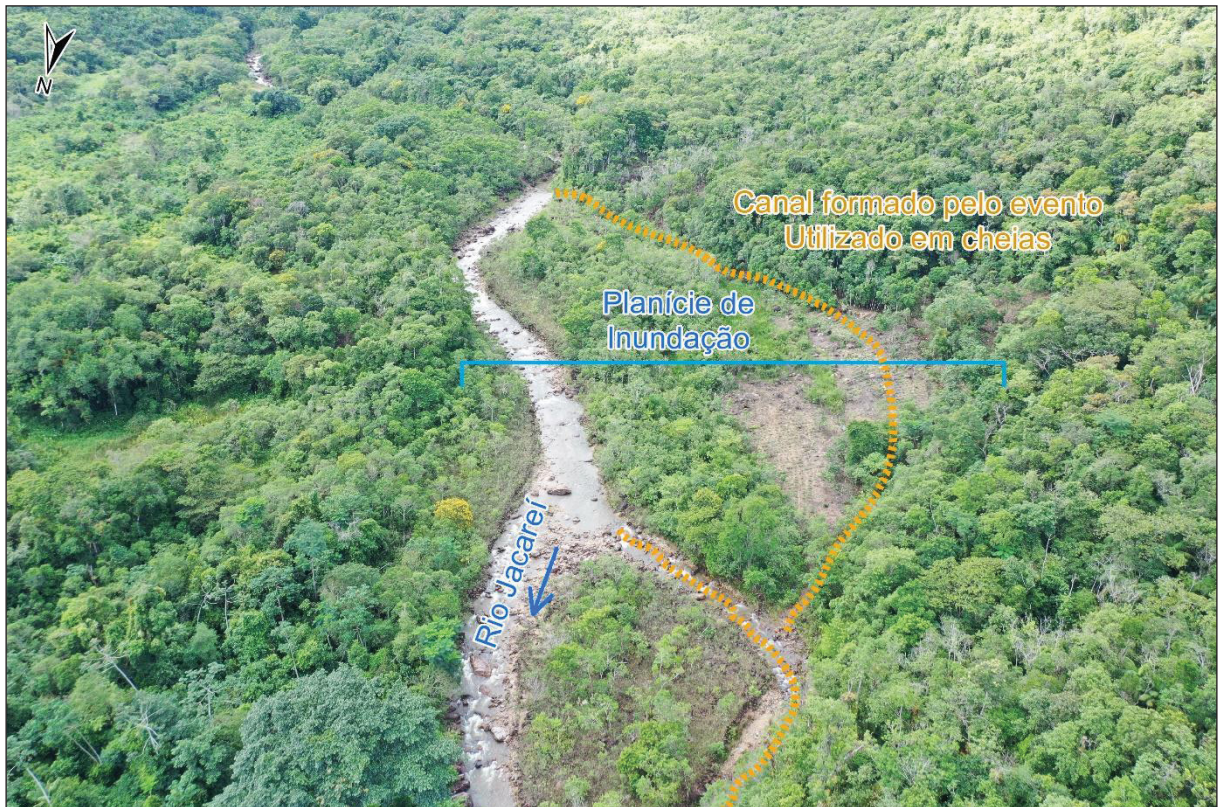
Figura 6.4 – Imagem obliqua da área com canais formados pelo evento. Coordenadas aproximadas: - 25.570222°/-48.703637°. Altitude da RPA: 60 metros.
