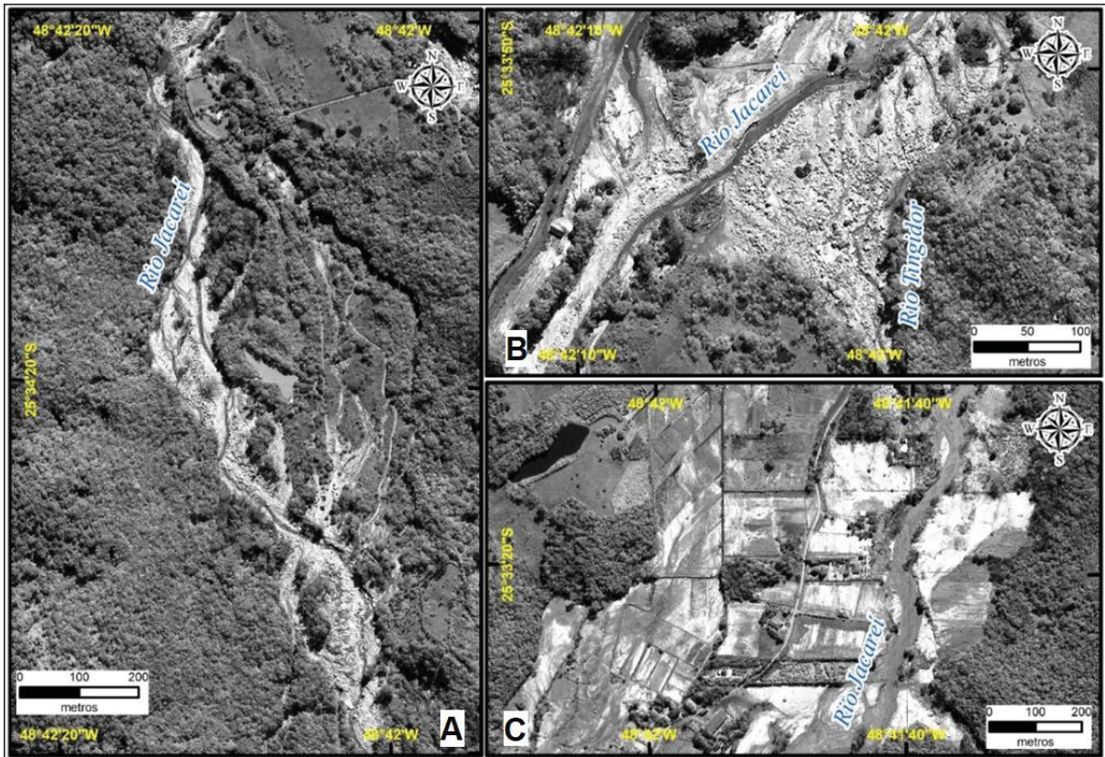
Figura 3.4 – Depósitos na BRJ formados pelos movimentos de massa de 2011 nos canais intramontanos (A), desembocaduras (B) e planície aluvial (C).
