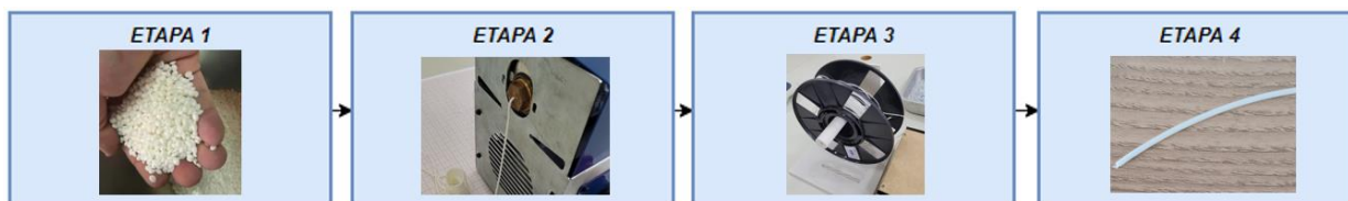
FIGURA 19 – ROTA DO SISTEMA PRODUTIVO PARA PRODUÇÃO DE FILAMENTOS DE IMPRESSÃO 3D A PARTIR DE PLÁSTICO VIRGEM.
