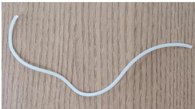
FIGURA 15 – FILAMENTO DEFORMADO DEVIDO CHOQUE TÉRMICO
