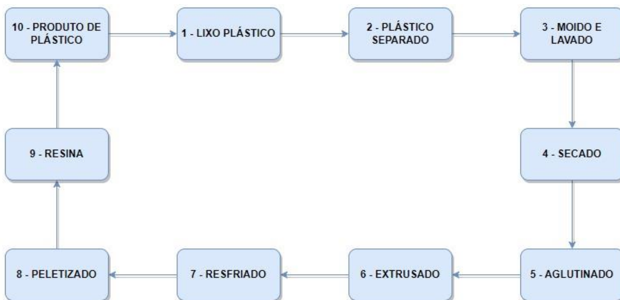
FIGURA 3 – FLUXOGRAMA DO PROCESSO DE RECICLAGEM MECÂNICA DO PLÁSTICO PÓS-CONSUMO
