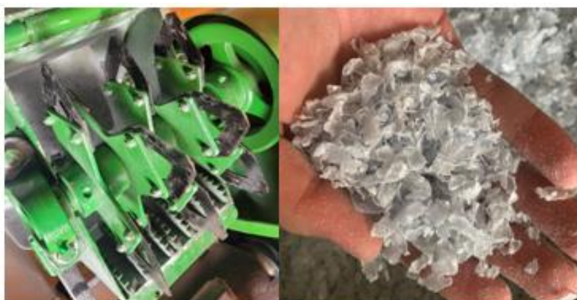
FIGURA 26 – PROCESSO DE TRITURAÇÃO DO MATERIAL RECICLADO E MATERIAL OBTIDO
