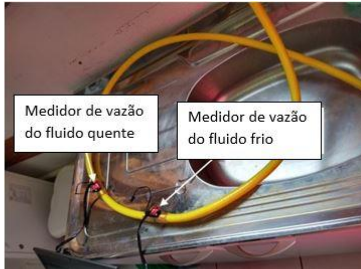
FIGURA A.1 - SENSORES DE VAZÃO NA MESMA CORRENTE DE ÁGUA PARA VALIDAÇÃO.
