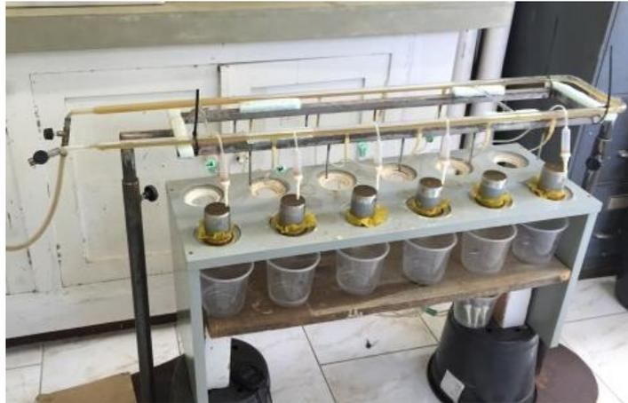
Figura 10 – Permeômetro de carga constante
