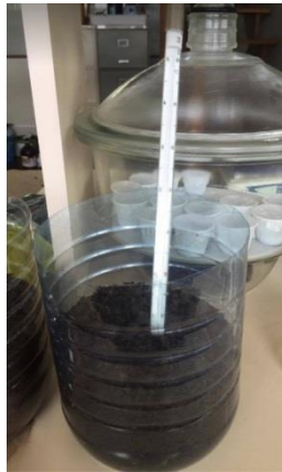
FIGURA 4 – VERIFICAÇÃO DA TEMPERATURA DO SOLO EM UMA AMOSTRA.
