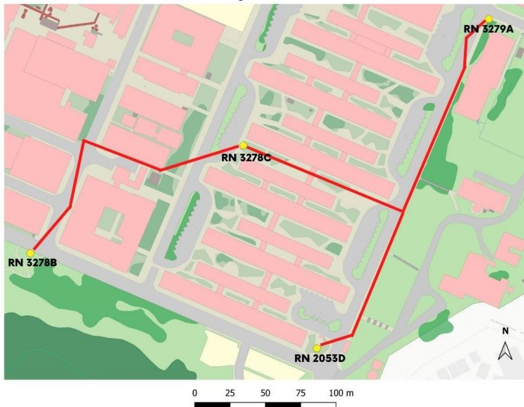
Figura 10 TRAJETO DAS 3 SEÇÕES DE NIVELAMENTO GEOMÉTRICO
