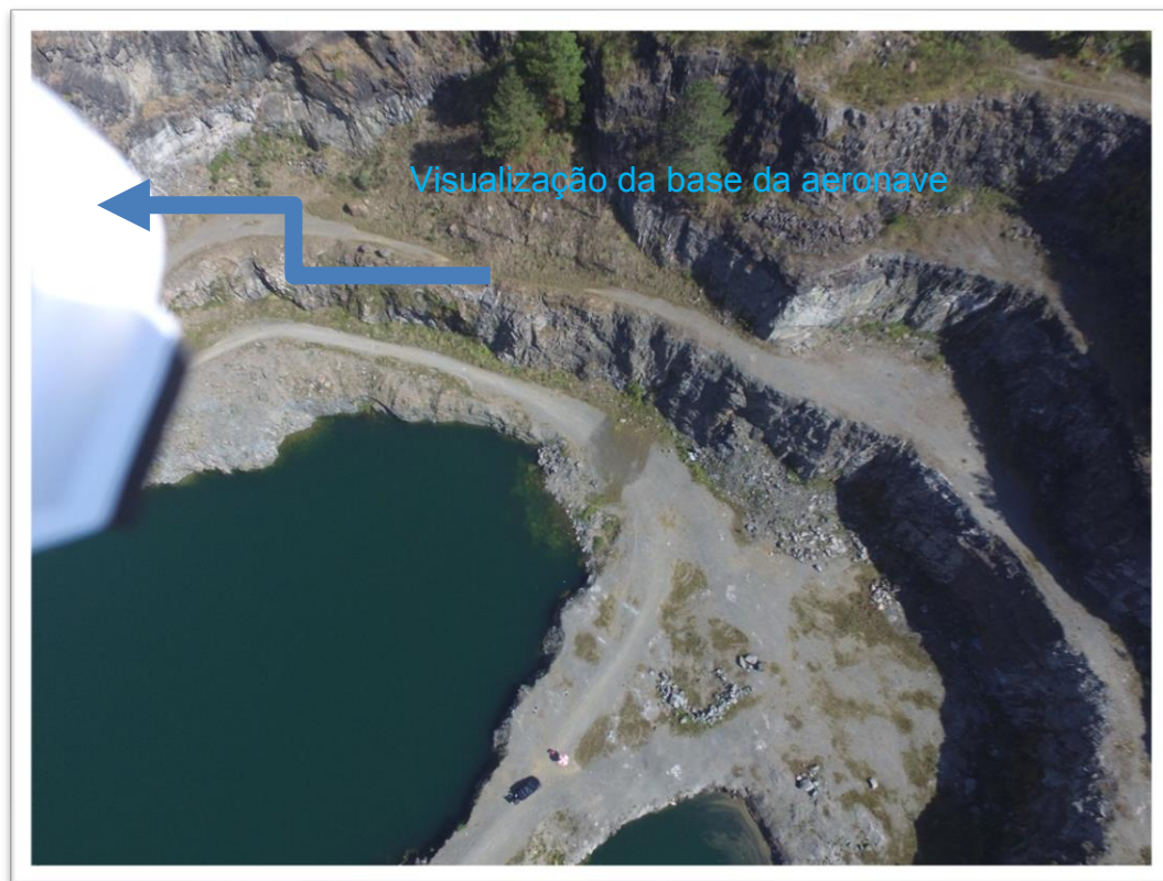
FIGURA 47 - OBSTRUÇÃO DO IMAGEAMENTO DA ÁREA DE ESTUDO OCASIONADA PELA ESTRUTURA DA AERONAVE
