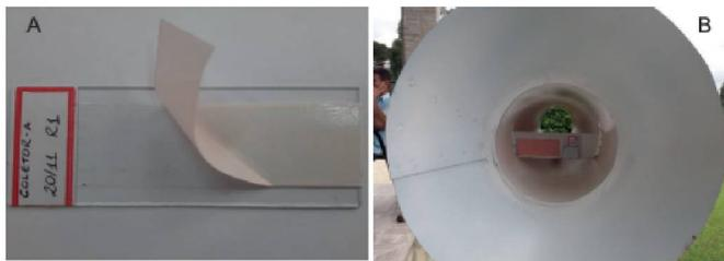
Figura 4. Lâmina de microscopia com fita adesiva dupla face e etiqueta de identificação (A). Visão interna do coletor de esporos (B). Fonte: [18].
