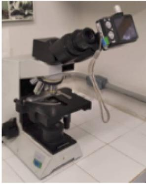
Figura 23. Microscópio óptico modelo Olympus XC40RF 100. Fonte: O Autor.
