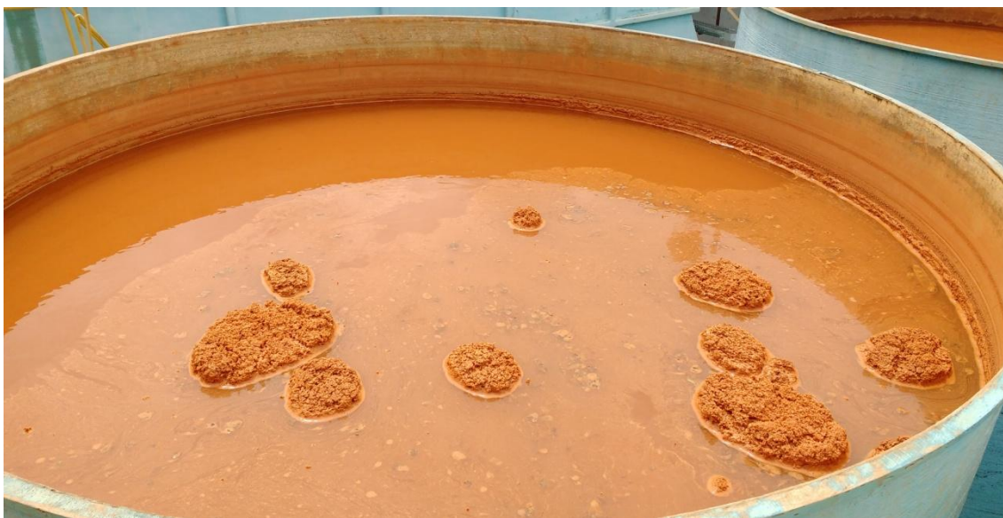
Figura 67: Formação de espuma no floculador do primeiro módulo de tratamento Fonte: Acervo Próprio, 2016
