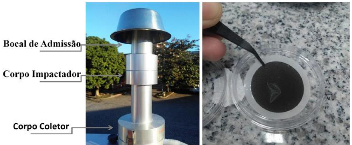
FIGURA 4 - IMPACTADOR INERCIAL DO TIPO HARVARD E FILTRO DE POLICARBONATO APÓS AMOSTRAGEM.
