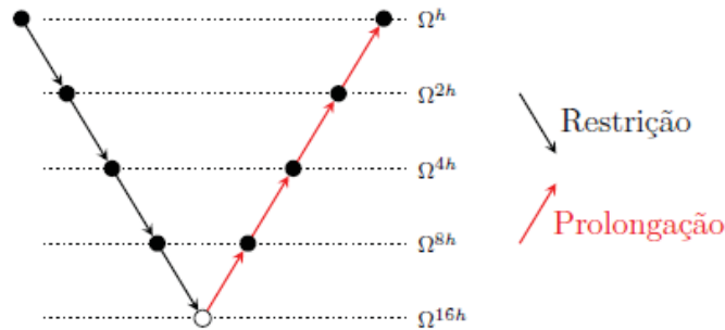
FIGURA 8 – CICLO V DO MULTIGRID , ONDE \bullet E \circ REPRESENTAM, RESPECTIVAMENTE, SUAVIZAÇÃO E SOLUÇÃO DO SISTEMA DE EQUAÇÕES.
