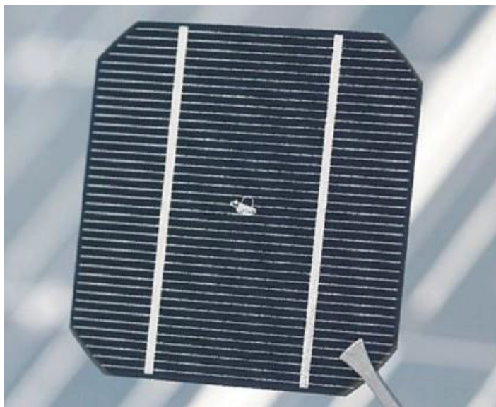
Figura 8 – Célula fotovoltaica de silício cristalino
