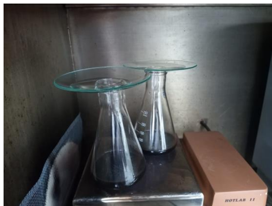
FIGURA 5 – FIM DA HIDRÓLISE ÁCIDA.
