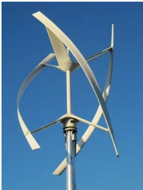
Figura 5: Aero gerador de eixo vertical.
