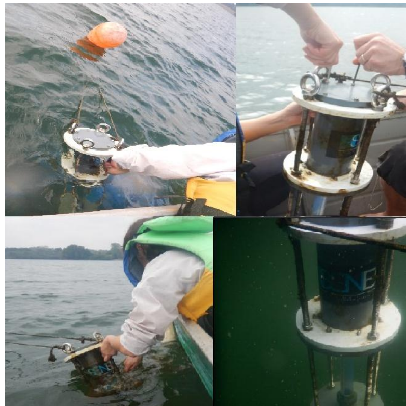
Figura 10 - Procedimento de coleta de dados de ebulição.
