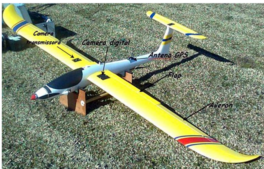
FIGURA 7: MODELO DE VEÍCULO AÉREO NÃO TRIPULADO (VANT) FONTE: SIMEPAR (2011)
