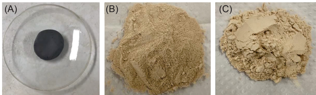
FIGURA 9- ARGILA ÚMIDA (A), ARGILA TRATADA TIPO A (B) E ARGILA TRATADA TIPO B (C)
