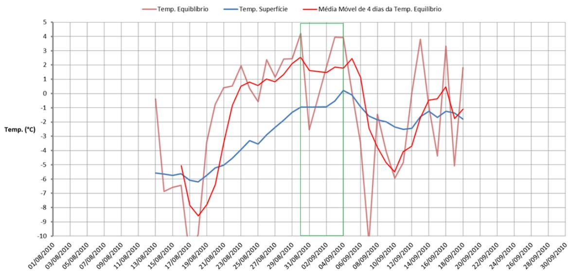
Figura 26 – Comparação de temperatura de equilíbrio (em Vermelho escuro), temperatura da água (em Azul) e média móvel da temp. de equilíbrio (Vermelho claro) para o Reservatório do Verde em 08-09/2010.
