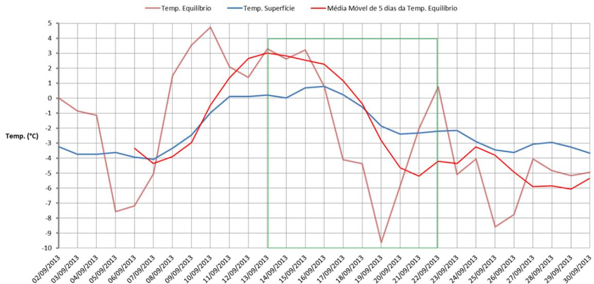
Figura 27 – Comparação de temperatura de equilíbrio (em Vermelho escuro), temperatura da água (em Azul) e média móvel da temp. de equilíbrio (Vermelho claro) para o Reservatório do Verde em 09/2013.
