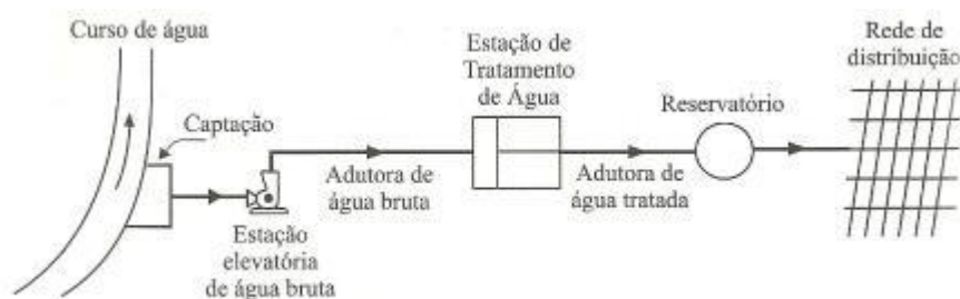
Figura 2. Sistema simples de abastecimento de água. Fonte: TSUTIYA, 2006.
