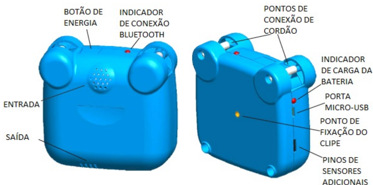
Figura 8 – Especificações do Equipamento Airbeam . FONTE: AirCasting (2010)
