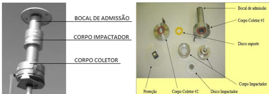
Figura 7: Arranjo esquemático do coletor de material particulado (impactador Harvard), à esquerda, bem como as componentes do amostrador, à direita.
