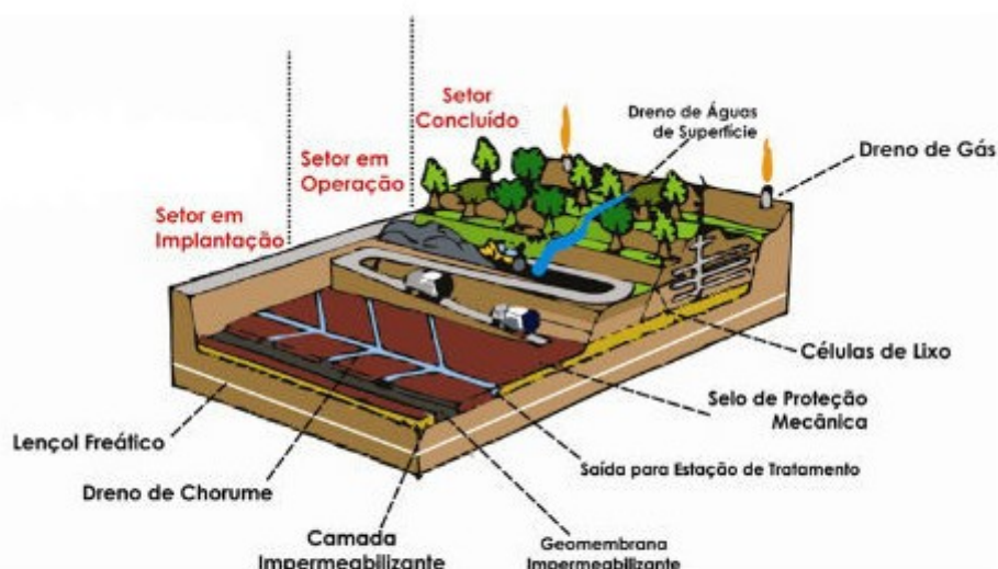
Figura 2: Esquema genérico de um aterro sanitário.
