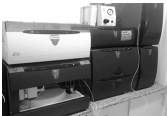
FIGURA 9 - CROMATÓGRAFO DE ÍONS DIONEX UTILIZADO PARA QUANTIFICAÇÃO DE ÍONS NOS FILTROS AMOSTRADOS. FONTE: BARBOSA, 2014.
