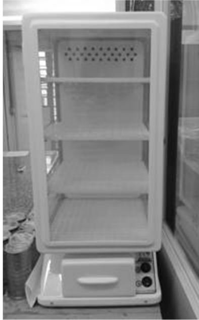
FIGURA 5 - DESSECADOR UTILIZADO PARA AMBIENTAÇÃO DOS FILTROS POR 24 HORAS ANTES DA PESAGEM. FONTE: POLEZER, 2013.
