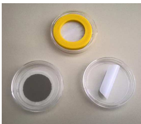
FIGURA 1 - FILTRO PRONTO PARA AMOSTRAGEM DE MATERIAL PARTICULADO 2,5 \mu m (ACIMA), FILTRO AMOSTRADO (ESQUERDA), FILTRO BRANCO (DIREITA).
