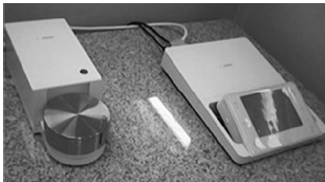
FIGURA 7 - MICROBALANÇA SARTORIUS UTILIZADA PARA A PESAGEM DOS FILTROS ANTES E APÓS A AMOSTRAGEM O CÁLCULO DA CONCENTRAÇÃO MÉDIA DE MP. FONTE: BARBOSA, 2014.
