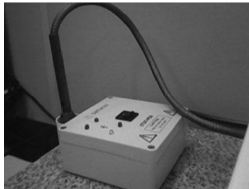
FIGURA 6 - CANETA ANTI-ESTÁTICA PARA RETIRADA DAS CARGAS SUPERFICIAIS ANTES DA PESAGEM DOS FILTROS. FONTE: BARBOSA, 2014.
