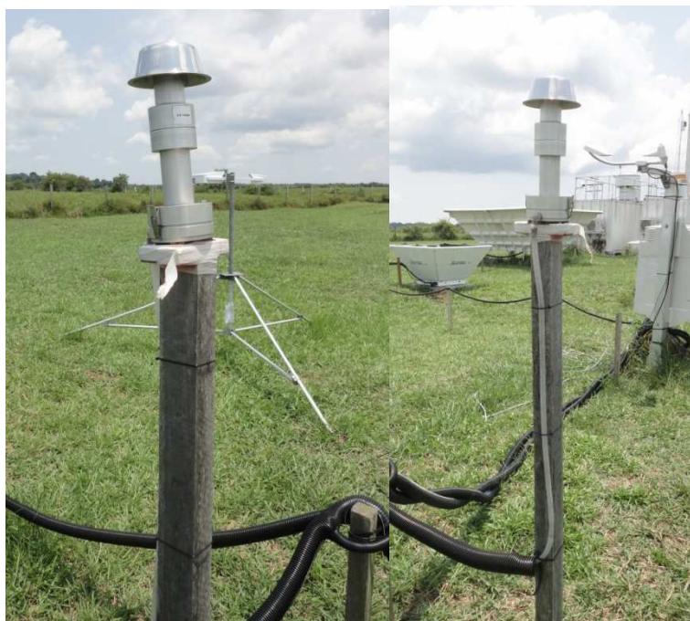
FIGURA 2 - AMOSTRADOR HARVARD UTILIZADO NA AMOSTRAGEM DE MP NOS FILTROS PARA IOP1 E A IOP2. FONTE: SARAH PARALOVO (2015).
