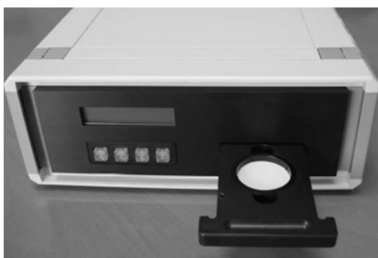
FIGURA 8 - TRANSMISSÔMETRO ÓTICO SOOTSCAN UTILIZADO PARA MEDIÇÕES DE BC DOS FILTROS AMOSTRADOS. FONTE: BARBOSA, 2014.
