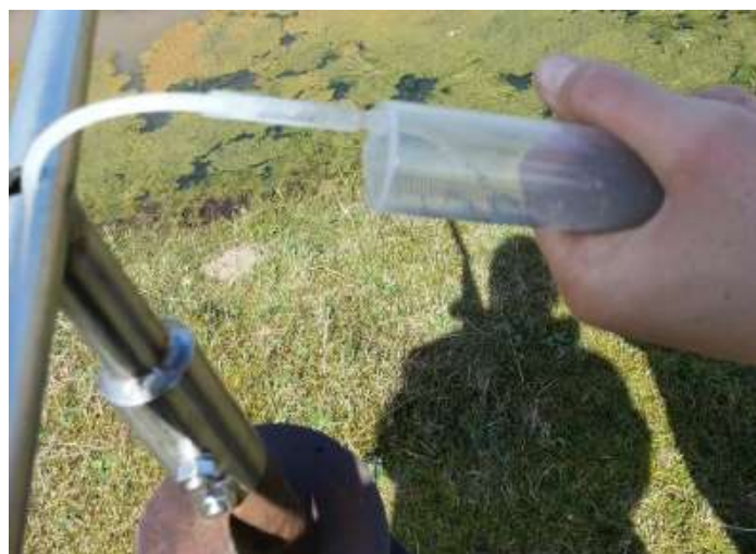
FIGURA 9: AMOSTRAGEM FEITA COM AUXÍLIO DE SERINGA, NA PARTE SUPERIOR DA BROCA ESPIRAL (SEÇÃO EM T)
