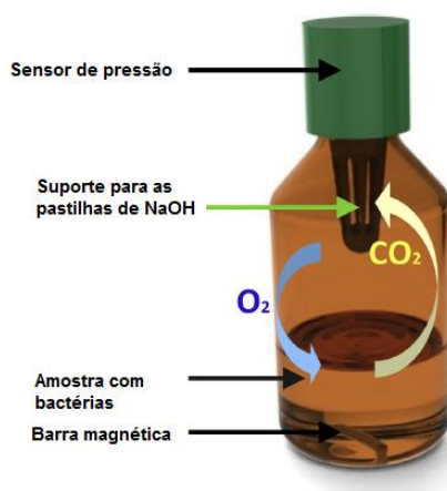
Figura 1- Princípio do funcionamento de medição de DBO por diferença de pressão
