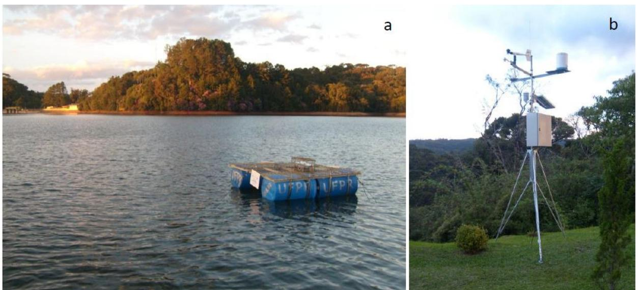
Figura 9 – Imagens da plataforma flutuante (a) e da estação meteorológica (b) no reservatório Vossoroca. FONTE: POLLI, 2014.
