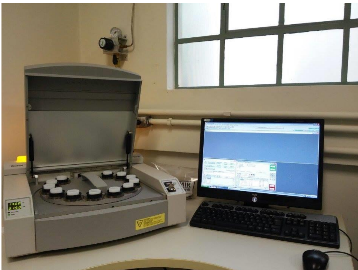
FIGURA 6: ESPECTRÔMETRO DE BANCADA EDXRF MINIPAL 4, PANALYTICAL, COM COMPUTADOR ACOPLADO PARA A ANÁLISE ELEMENTAR FONTE: GABRIELA POLEZER (2015)
