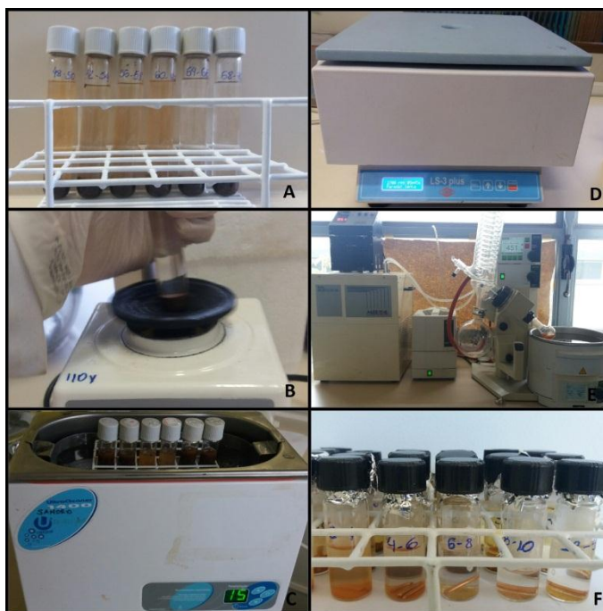
FIGURA 4: PROCEDIMENTO DE EXTRAÇÃO: A) ADIÇÃO DE SOLUÇÃO SOLVENTE; B) HOMOGENEIZAÇÃO EM VORTEX; C) EXTRAÇÃO ULTRASSÔNICA; D) CENTRIFUGAÇÃO; E) CONCENTRAÇÃO EM ROTAVAPOR; F) ADIÇÃO DE COBRE ATIVADO.
