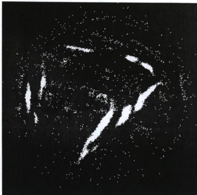
**Figura 53 - Imagem resultante da operação de limiarização global.**
