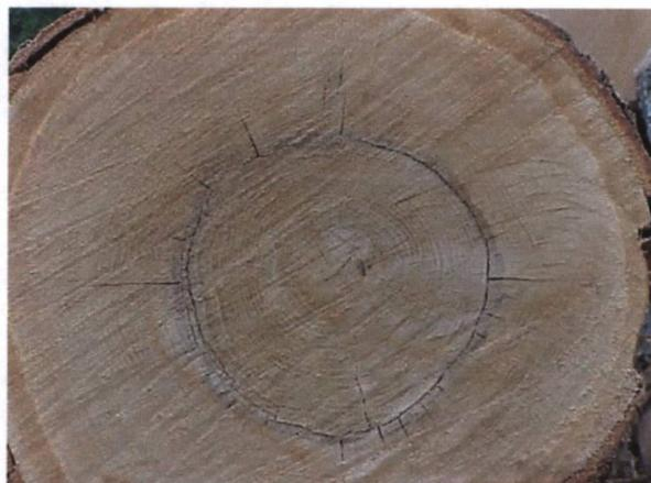
**Figura 7 – Fotografia de um tronco com rachadura em forma de anel.**
