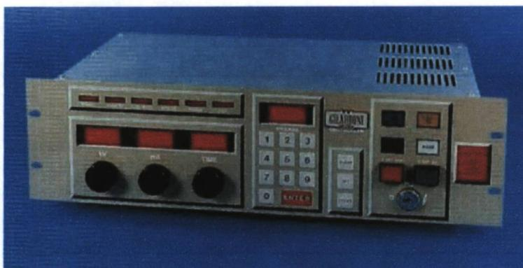
**Figura 41 - Unidade de controle do gerador de raios X.**
