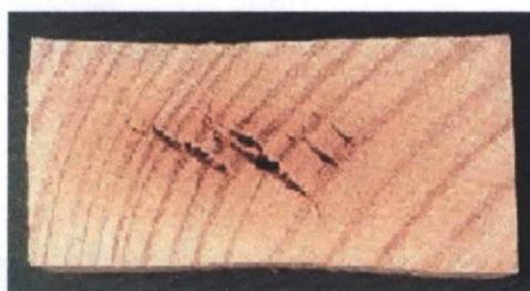
**Figura 6 - Fotografia de uma peça de madeira com rachaduras internas.**
