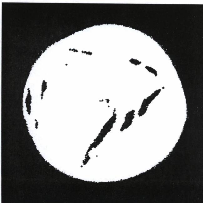
**Figura 56 - Subtração da imagem dos defeitos da imagem da amostra preenchida.**
