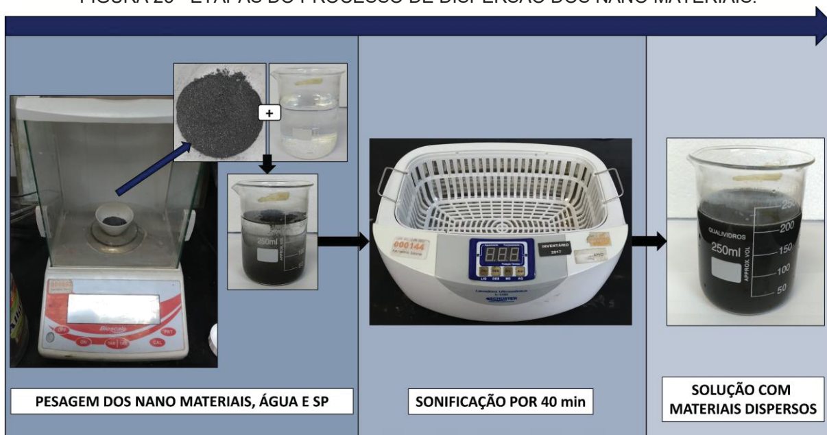
FIGURA 23 - ETAPAS DO PROCESSO DE DISPERSÃO DOS NANO MATERIAIS.
