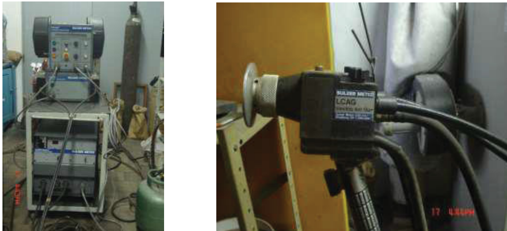
FIGURA 12 - EQUIPAMENTO DE ASPERSÃO TÉRMICA POR ARCO ELÉTRICO
