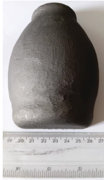
FIGURA 27 - MODELO DE ALUMÍNIO COM APLICAÇÃO DE DESMOLDANTE
