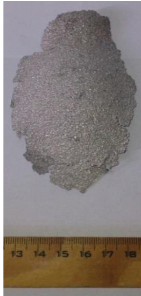
FIGURA 32 - CASCA DE ALUMÍNIO ER4043 GERADA SEM APLICAÇÃO DE DESMOLDANTE
