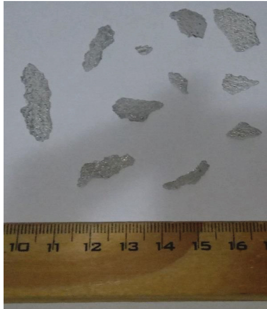
FIGURA 31 - CASCA DE ALUMÍNIO ER4043 GERADA COM APLICAÇÃO DE DESMOLDANTE
