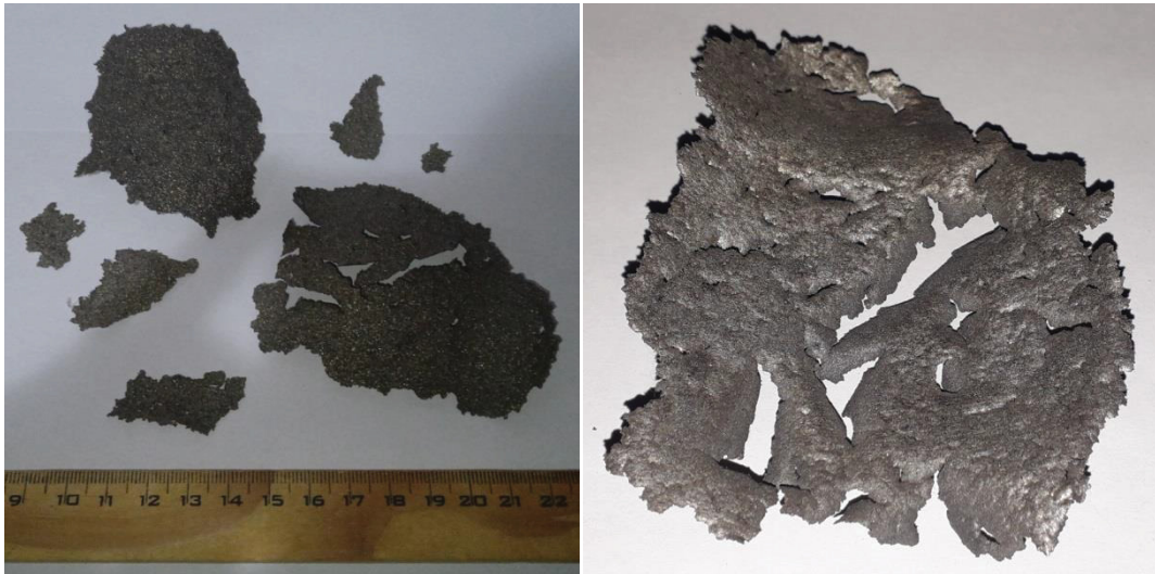
FIGURA 29 - CASCA DE AÇO 304L GERADA COM APLICAÇÃO DE DESMOLDANTE
