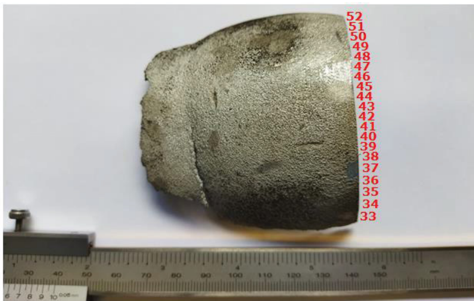
FIGURA 38 - PONTOS ONDE FORAM MEDIDAS AS ESPESSURAS DA CASCA DE ALUMÍNIO CORTADA
