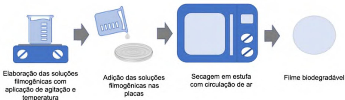
FIGURA 1.10 – ESQUEMA REPRESENTATIVO DA TÉCNICA DE CASTING PARA PRODUÇÃO DE FILMES BIODEGRADÁVEIS
