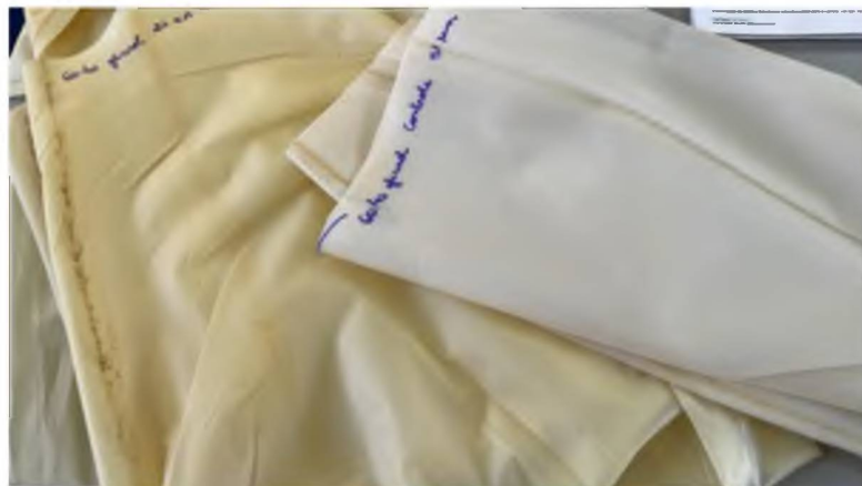
FIGURA 4.2 – FILMES FC/PBAT OBTIDOS POR EXTRUSÃO TUBULAR
